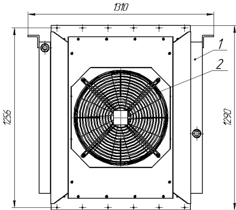
Рисунок 7. Блок охлаждения.
