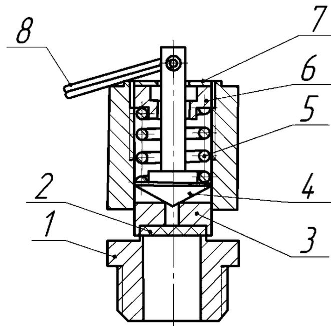
Рисунок 6. Клапан предохранительный.
