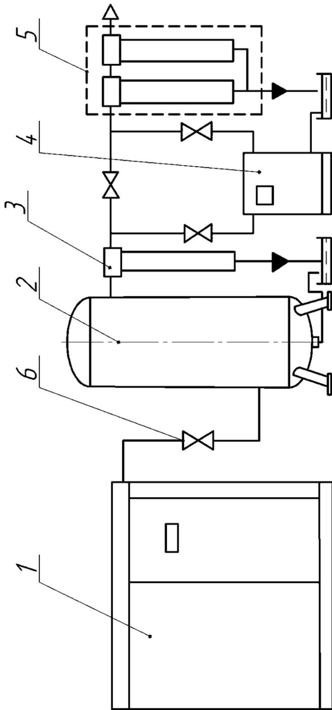
Рисунок 1. Схема подключения установки компрессорной к пневмосети.
